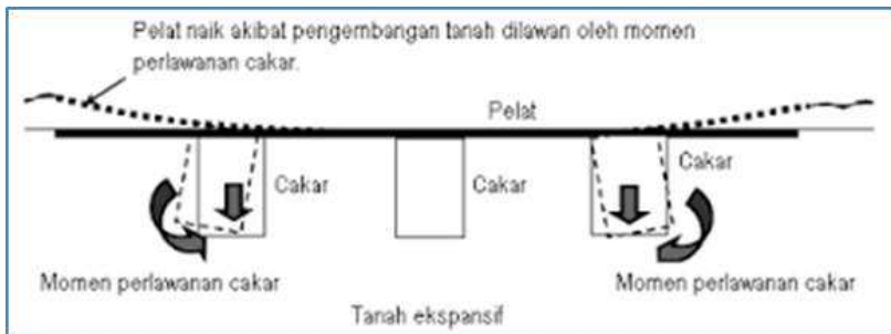
Gambar 5.5 Mekanisme momen perlawanan cakar terhadap Gerakan naik pelat akibat pengembangan tanah dasar (Hardiyatmo 2008)
