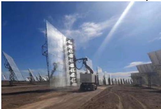
Gambar 5.8 Proses pembersihan cermin heliostat pada plant solar tower [51]
