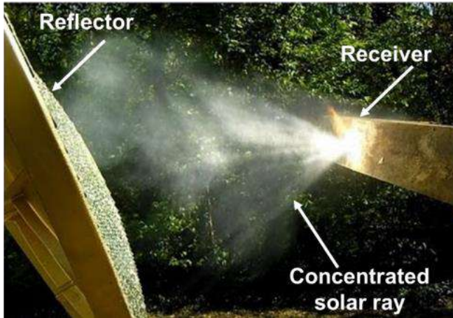
Gambar 3.3 Ilustrasi prinsip konversi photo to thermal sistem CSP [37]
