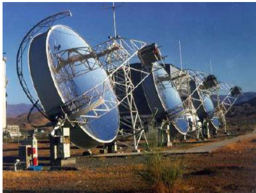
Gambar 6.7 Sistem polar tracking untuk dish dengan metal membrane [58]
