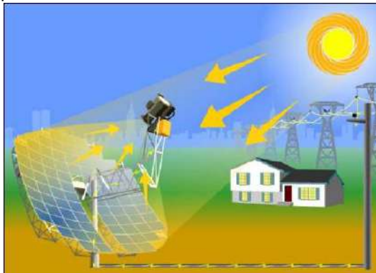
Gambar 6.2 Skema pemantulan cahaya dari dish concentrator ke arah receiver [27]
