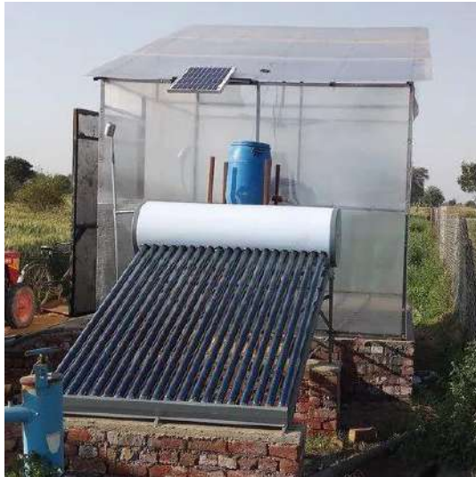
Gambar 2.15 Hibridisasi photoelectric dan photothermal untuk proses pengeringan hasil pertanian [33]
