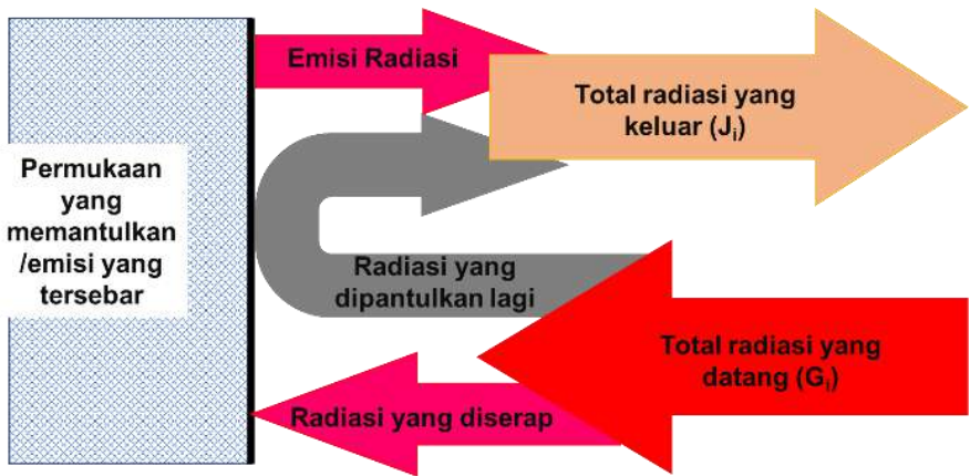
Gambar 3.13 Model kesetimbangan energi pada receiver [42]
